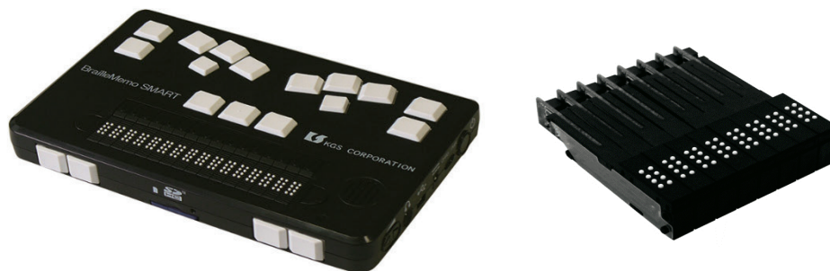
点字ディスプレイ（左）と点字セル（右）
